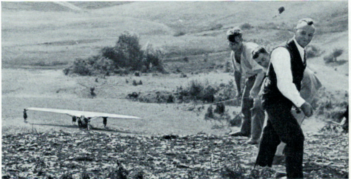
Tallandung am Hornberg. Die Maschine wird mittels Motorwinde an den Startplatz gezogen
